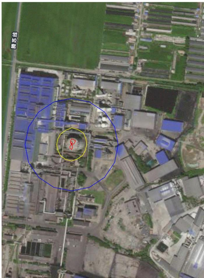
图 4-6 煤气柜的外部安全防护距离
