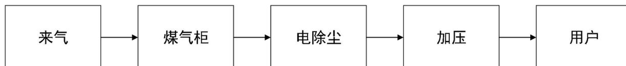
图 2-8 工艺流程框图
